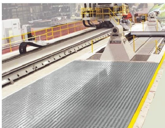
STEELFLEX na stroji pro zpracování skelných vláken/ STEELFLEX on a machine for glass fiber processing
