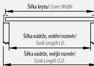
Čelní pohled / Front view
